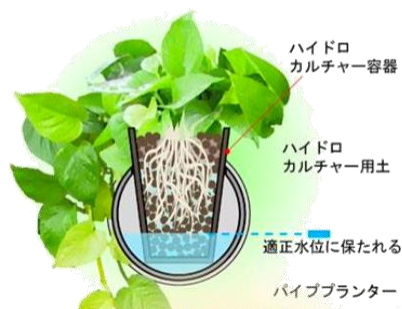
－ プランター内部の仕組み 断面図 －
