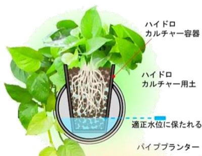
－ プランター内部の仕組み 断面図 －
